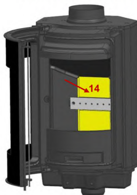
14 : Poser le réfractaire haut sur le dessus de la boîte à air et contre le fond.
