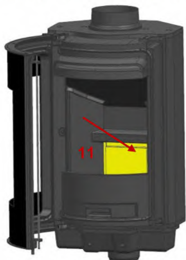
11 : Poser le réfractaire bas sur la sole foyère et contre le fond
