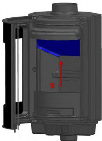
9 : Maintenir le déflecteur dans le haut du corps avec la main pendant la mise en place des réfractaires.
